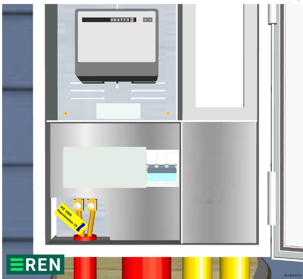
Figur 107 Merkelapp som henges på jordledning som er terminert i tilknytningsskap.
