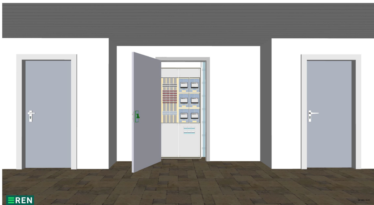
Figur 84 Eksempel på etasjefordeler i boligblokk - 6 målere
