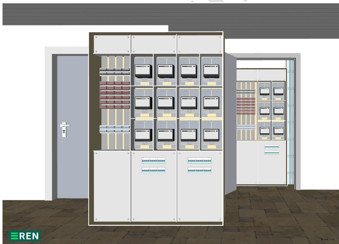
Figur 85 Eksempel på etasjefordeler i boligblokk - 12 målere
