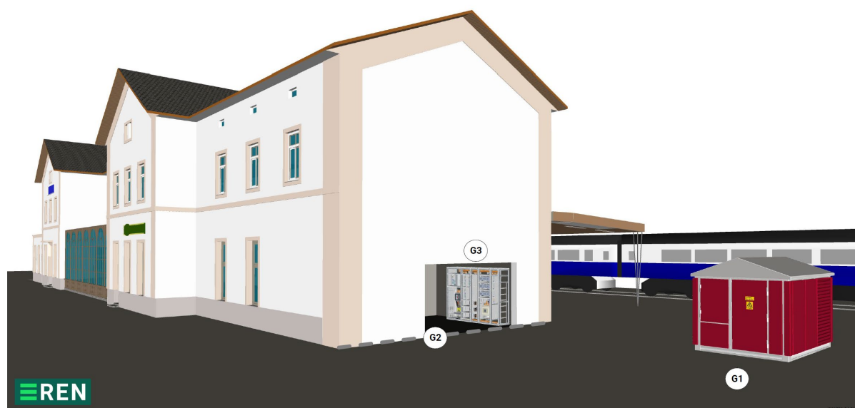
Figur 56 Illustrasjon på forsyning av hovedfordeling fra nettstasjon
